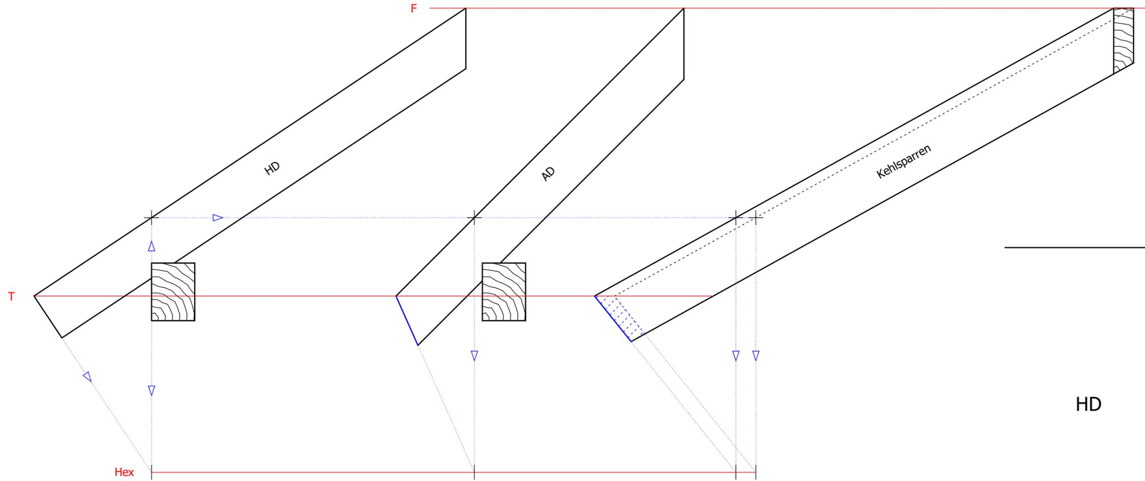
Durch die Senkelmethode bleiben die Abschnittsschmiegen am Kehlsparren alle gleich, d.h. die Abschnittsschmiege links/ rechts und in der Mitte verlaufen in der Profilsicht und im Grundriss parallel zueinander.
