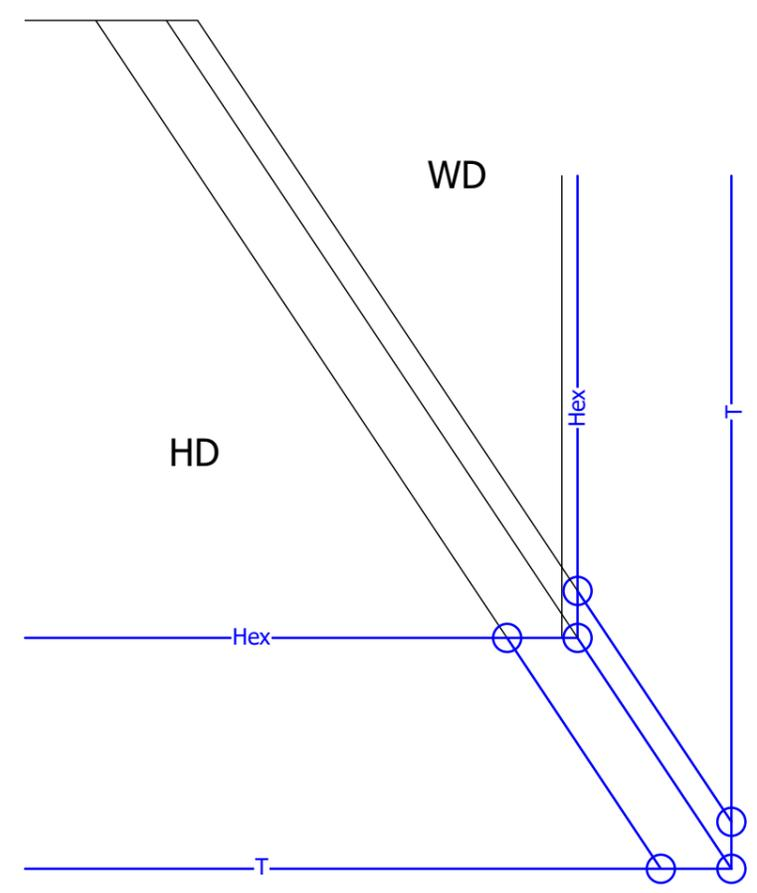
Durch die Senkelmethode bleiben die Abschnittsschmiegen am Gratsparren alle gleich, d.h. die Abschnittsschmiege links/ rechts und in der Mitte verlaufen in der Profilsicht und im Grundriss parallel zueinander.
